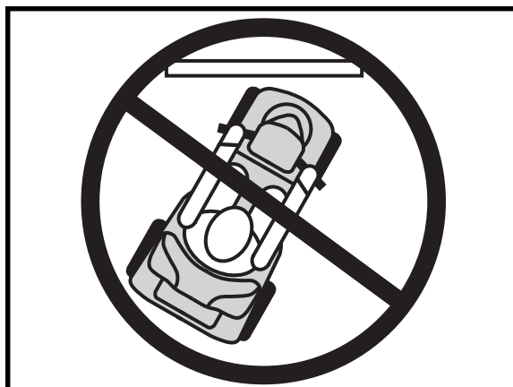
Abb. 3A. Falsches Anfahren einer Bordsteinkante
