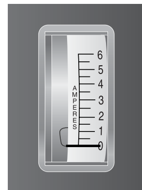
Abb. 8. Amperemeter (zeigt Vollgeladene Batterien an)
