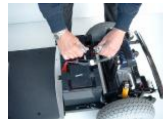
Abb. 31 – Batteriestecker 2 mal ziehen
