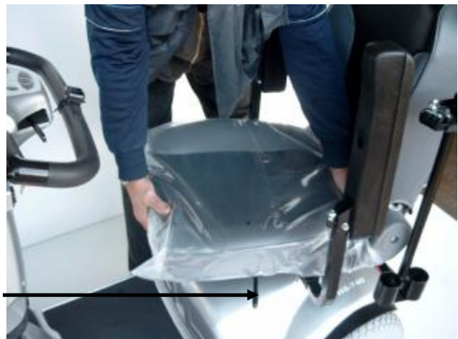
Abb. 10 beide Hände greifen von oben unter den Sitz
