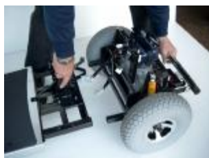
Abb. 35 – Hinterteil vom Vorderteil entnehmen
