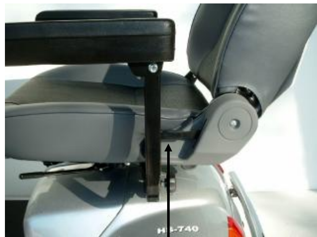
Abb. 8 Bedienhebel zur Verstellung der Rückenlehne
