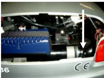
Abb. 11 Fahrposition, drücken Sie den Hebel nach unten
