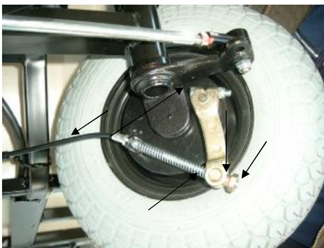
Abb. 13 Ölen mit Nähmaschinenöl
