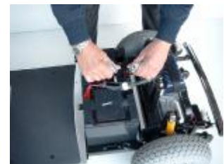
Abb. 28 – Batteriestecker 2 mal ziehen
