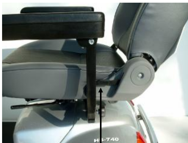
Abb. 6 Bedienhebel zur Verstellung der Rückenlehne
