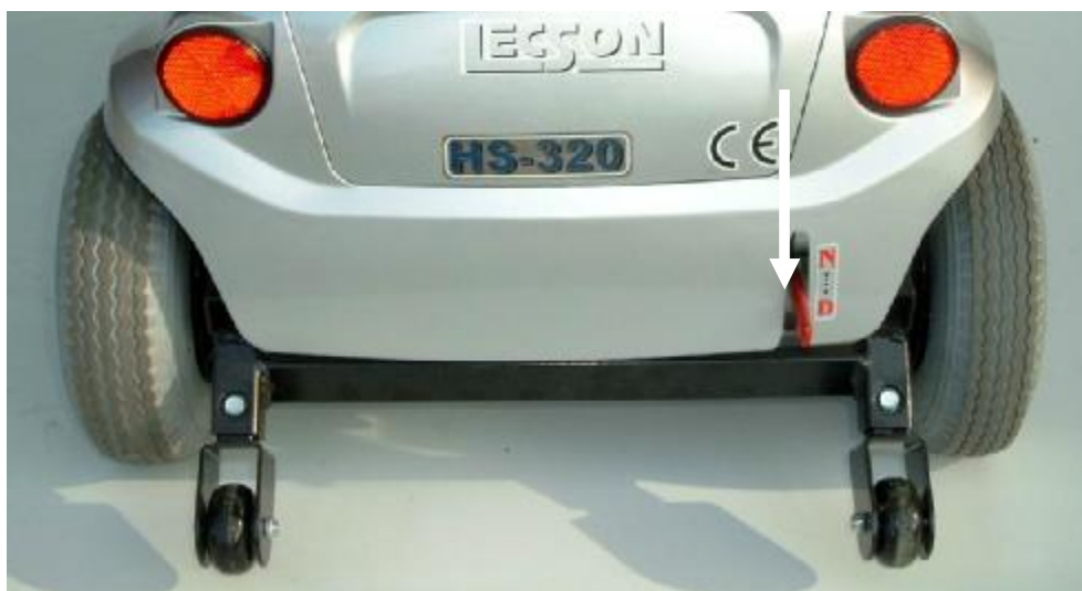
Abb. 6 Fahrposition, drücken Sie den Hebel nach unten Schiebeposition, ziehen Sie den Hebel nach oben
